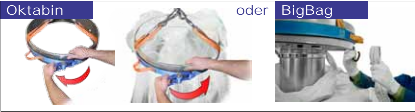
Folienspannung einfach öffnen Folie einspannen BigBag Schlaufen einhängen
