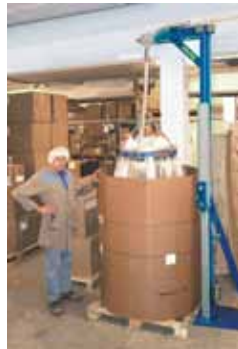
Folienspannung einfach öffnen Folie einspannen BigBag Schlaufen einhängen
